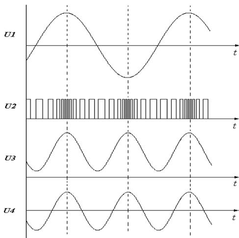
$U_1$  – форма сигнала, приходящего на вход системы и на вход ААДМ,  $U_2$  – сигнал на выходе асинхронного адаптивного ДМ,  $U_3$  – форма сигнала на выходе ЧД,  $U_4$  – форма сигнала после фильтра  $\Phi$ .
