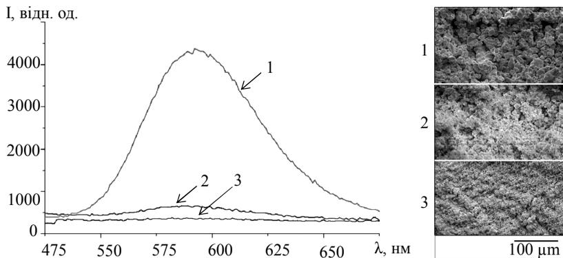
Рис. 1. Спектр ФЛ мікрочастин  $\text{ZnS:Mn}$  ( $\lambda_{\text{збудж}} = 365$  нм,  $T = 300$  К) та морфологія поверхні досліджених зразків: тривалість диспергування 0 (1), 10 (2) та 20 (3) хвилин відповідно.
