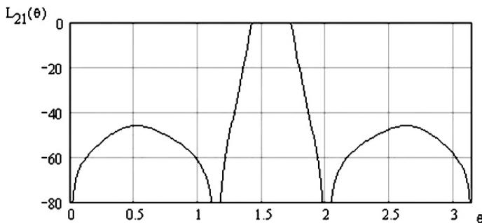
Рис. 2. Частотная зависимость рабочего затухания фильтра с нормированными к  $\rho_0$  параметрами:  $\rho_{D1} = 1.953$ ,  $\rho_{L1} = 1.772$ ,  $\rho_{S1} = 0.470$ ,  $\rho_{L2} = 2.1213$ ,  $\rho_{S2} = 0.125$
