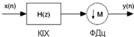
Рис. 2. КИХ-фільтр-дециматор
