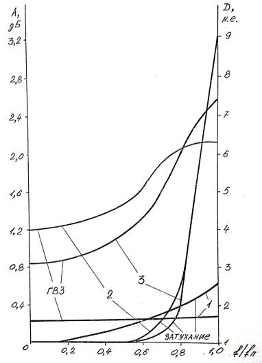
Рис. 2. Частотные характеристики дискретных фильтров 4-го порядка в полосе пропускания
