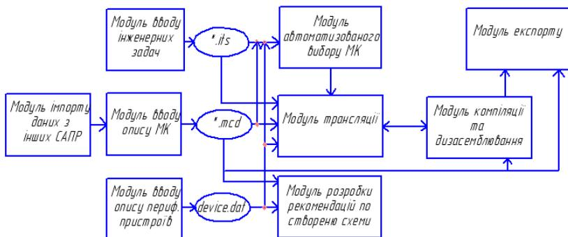
Рис. 1. Структурна схема програмного комплексу автоматизації програмування мікроконтролерів
