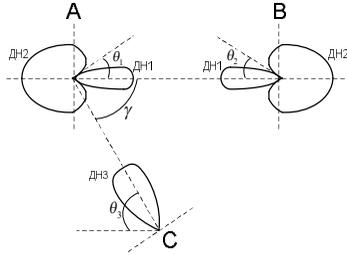
Рис. 1. Схема расположения антенн легитимного и отводного каналов
