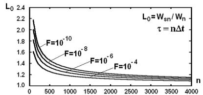
Рис. 2. Графіки залежності порогу прийняття рішення  $L_0$
