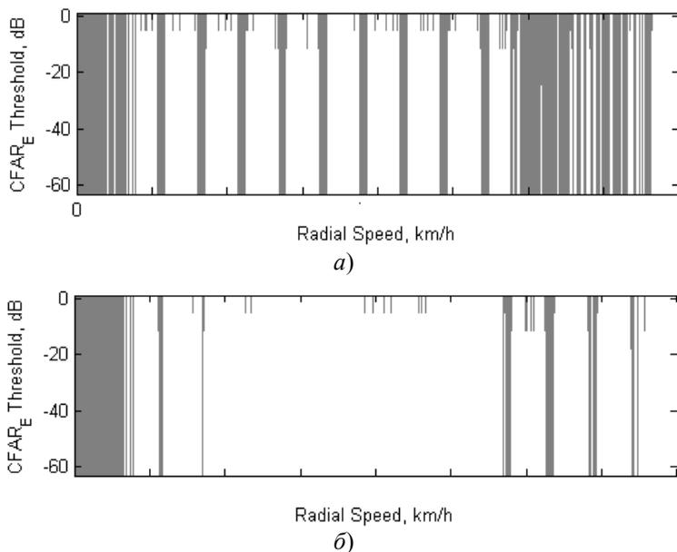
Рис. 1. АСХ РЛС до оптимизации (а) и после (б)
