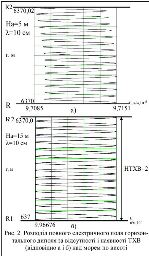
Рис. 2. Розподіл повного електричного поля горизонтального диполя за відсутності і наявності ТХВ (відповідно а і б) над морем по висоті
